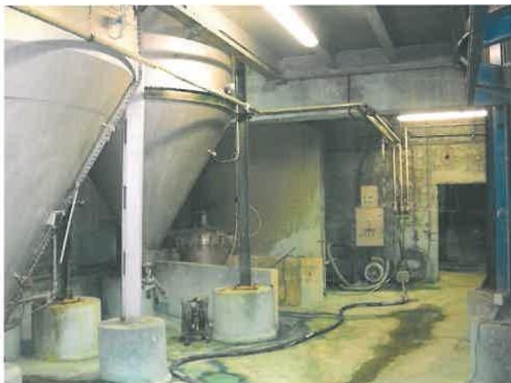
Réacteurs de la dissolution de sulfate de cuivre
