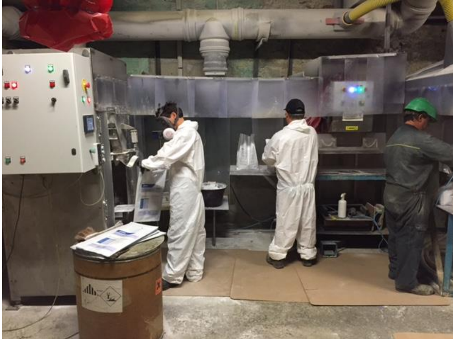
Chaîne de conditionnement composée d'une ensacheuse automatique et d'une soudeuse
